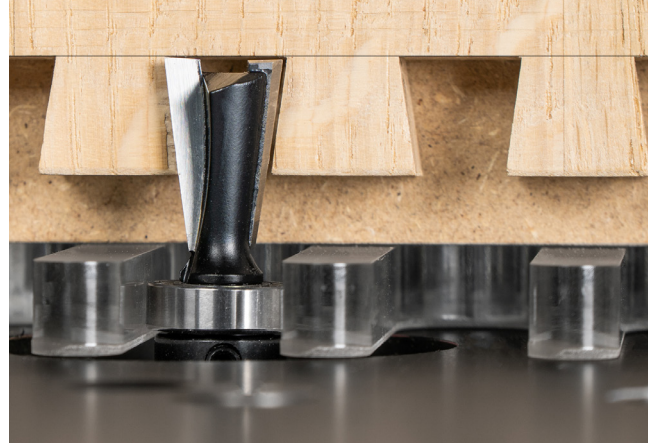
Abbildung 4: Der Anlaufring läuft beim Fräsen der Schwalbenschwanzzinken an der Schablone entlang.
