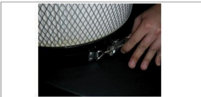
2. Stützen Sie die Kanisterfilterbaugruppe von unten ab und lösen Sie die federbelastete Bandklemme oben an der Kanisterfilterbaugruppe.
