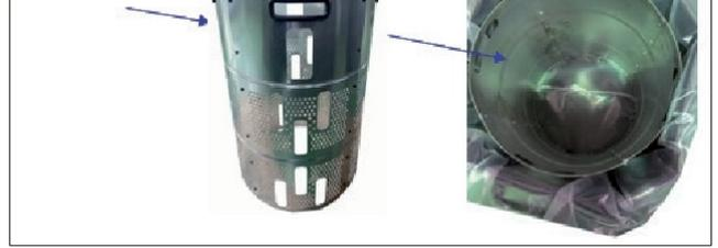
Schritt 32. Heben Sie die Fußpedalstange an. Richten Sie das achteckige Fassfenster auf den Mittelpunkt des Fassdeckels aus und drücken Sie das Fass hinein. Senken Sie die Fußpedalstange ab, um die Trommel für den normalen Maschinenbetrieb dicht zu verschließen.
