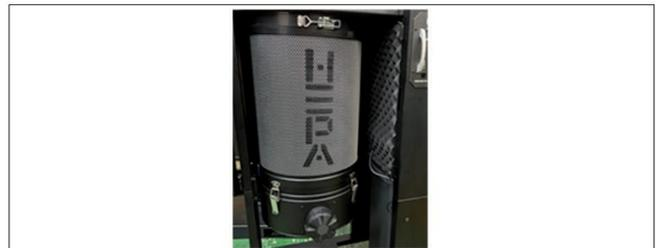
2. Während der Zyklon den Staub aus dem Inneren der Endkappe des Behälters auffängt, verwenden Sie Druckluft und eine Luftpistole und blasen Sie die Außenfläche des Behälters aus.
