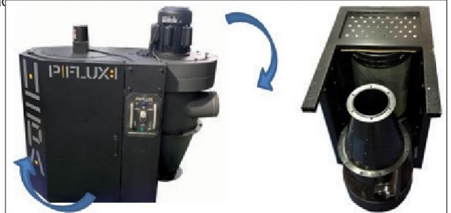
Schritt 2. Entfernen Sie den Sockel, der mit den (3) oberen Pfostenstützen verschraubt ist. Bewahren Sie diese Bolzen für Schritt 4 auf.
