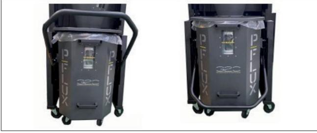
Schritt 33: Achten Sie beim Ausrichten der Trommel darauf, dass sowohl die linke als auch die rechte Hubplatte über der Spitze der Fußpedalstange liegen, bevor Sie die Fußpedalstange anheben. Wenn die Trommel nicht ausgerichtet ist, ist sie nicht vollständig abgedichtet und der Luftstrom wird behindert.
