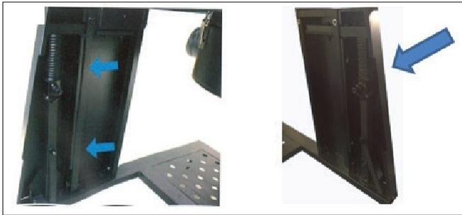
Schritt 16. Befestigen Sie die beiden Enden des Octagon-Fußpedals an der Mutter auf der Fußpedalstange.
