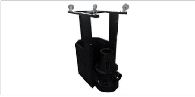
Schritt 6. Sichern Sie die (3) aufrechten Verstärkungsplatten mit (12) 5/16" x 3/4" Sechskantschrauben und (12) 5/16" Unterlegscheiben.
