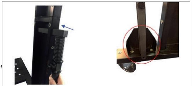
Schritt 13. Befestigen Sie das obere Ende der Fußpedalstange an der Halterung mit (4) 5/16" x 1-3/4" Sechskantschrauben, (8) 5/16" x 18x2mm Unterlegscheiben und (4) 5/16" Sechskantmuttern. Vergewissern Sie sich, dass die Fußpedalstange ganz bis zum Ende der Halterung geschoben ist (durch gelbe Pfeile gekennzeichnet). Führen Sie die gleichen Schritte für die gegenüberliegende Seite durch.
