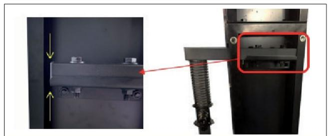
Schritt 14. Befestigen Sie die Basis der Fußpedalstange an der dreieckigen Stützplatte, indem Sie die untere Stützplatte senkrecht gegen die Fußpedalstange halten und den mitgelieferten U-Kanal mit (2) 5/16" x 3/4" Sechskantschrauben, (4) 5/16" x 18x2mm Unterlegscheiben und (2) 5/16" Sechskantmuttern von innen nach außen an der Fußpedalstange befestigen. Führen Sie die gleichen Schritte für die
