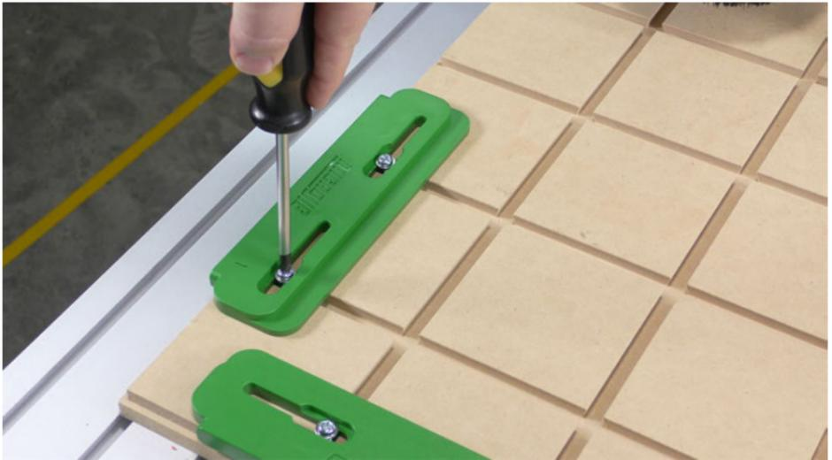
Fig 1b - Montage der Edge Guide
