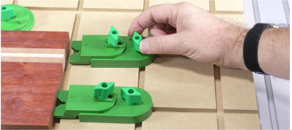
Fig 6a - Verwendung der Ramp Clamp
