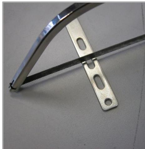
Verschrauben an der Haltevorrichtung der Montageplatte. Erforderliche Löcher im OFL 1.0 sind bereits vorgebohrt. Gegebenenfalls muss die Magnethalterung in der Länge angepasst werden.
