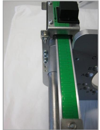
Montage der Messskala an der Unterseite der Einlegeplatte.
