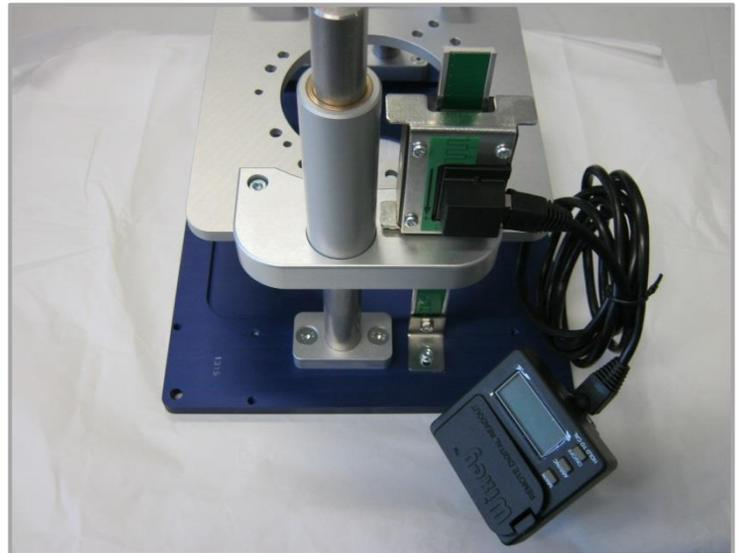
Befestigung der Messskala an der Unterseite der Einlegeplatte. Die Löcher hierfür sind bereits vorgebohrt.
