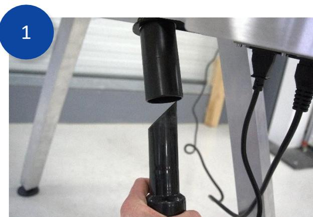
Befestigen Sie den Absaugschlauch an der Unterseite des *X-Beam Lower*
