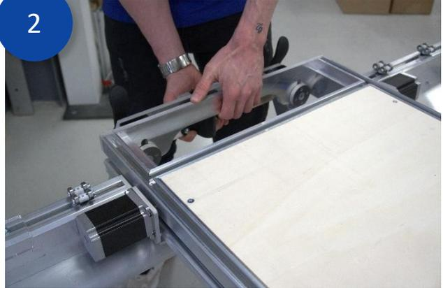
Heben Sie die *Y-Bank* an, um die Fixierstifte des *Beinsets* aufzunehmen. Schieben Sie die Beinklemmstifte in die Schlitz in der Endplatte der *Y-Bank*.
