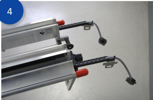
Schieben Sie die Kabel an der Schlepptettenverriegelungsplatte so, dass sie flach liegen und aus dem Ende des *oberen X-Trägers* herausragen.
