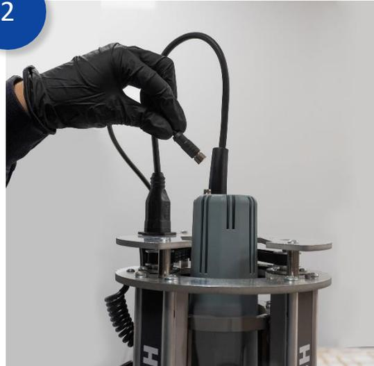
Entfernen Sie das Kabel des Geschwindigkeitsreglers
