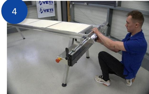
Stellen Sie sicher, dass die Räder mit den Kanälen ausgerichtet sind, und schieben Sie den *Beinsatz* an den X-Träger auf den Y 6
