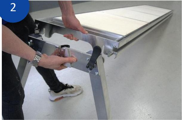
Montieren Sie am gegenüberliegenden Ende der Bank das *Bein-Set 1* indem Sie zunächst die Beine ausklappen.
