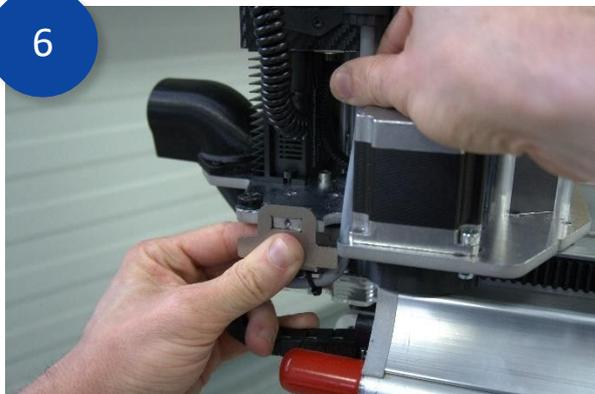
Legen Sie die Schlepptettenverriegelungsplatte über
