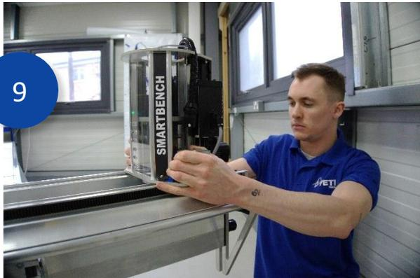
Sie können nun den Z-Kopf auf den oberen X-Träger schieben, bis alle Räder eingerastet sind.
