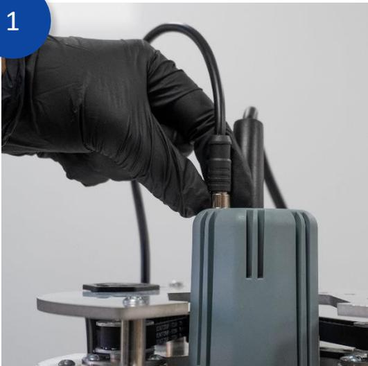
Schließen Sie das Kabel des Geschwindigkeitsreglers wieder an und achten Sie darauf, dass der Gewindekragen
