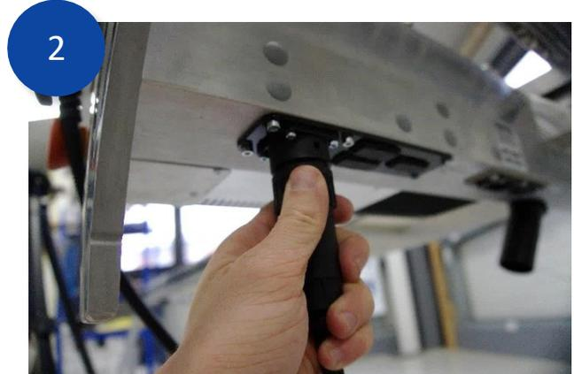
Stecken Sie das Kabel in den Anschluss und drehen Sie die Manschette im Uhrzeigersinn, um sie zu sichern.
