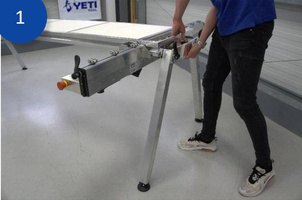
Heben Sie die *Y-Bank* an der Endplatte an, und nehmen Sie mit der anderen Hand das *Bein-Set 2*.
