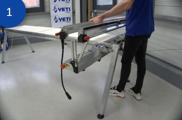
Schieben Sie den *oberen X-Träger* wie oben gezeigt auf den *unteren X-Träger*.
