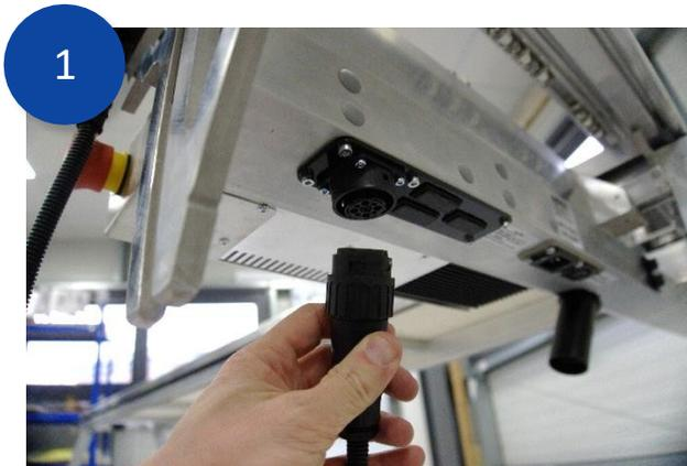
Der Amphenol-Stecker wird mit der Buchse an der Unterseite des *X-Beam Lower* verbunden.
