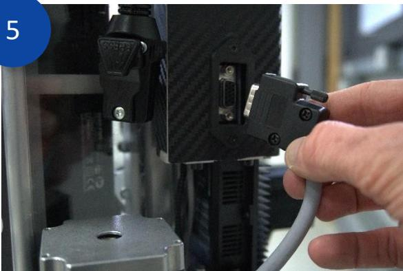
Stecken Sie das Signalkabel ein und sichern Sie es mit der
