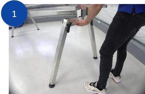
Klappen Sie ein *Beinsatz* aus. Heben Sie die *Y-Bank* am Ausgangsende an.
