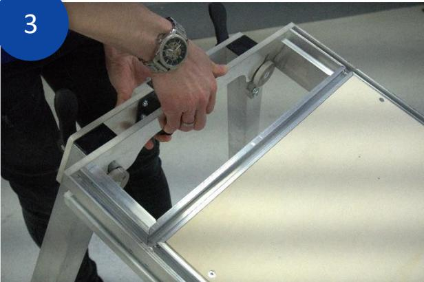
Heben Sie die *Y-Bank an*, um die Fixierstifte des *Beinsets* aufzunehmen. Schieben Sie die Beinklemmstifte in die Schlitze in der Endplatte der *Y-Bank*.
