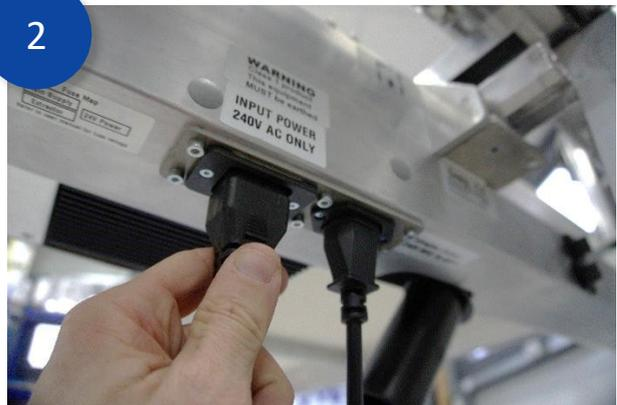
Stecken Sie das Kabel in den Anschluss an der Unterseite des X-Beam Lower.
