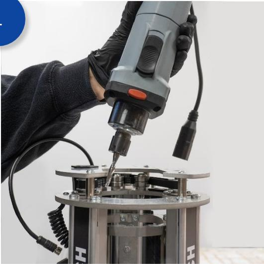
Nachdem Sie den Fräser gewechselt haben, setzen Sie die Spindel vorsichtig wieder in den Käfig ein, wobei der Spindelschalter nach vorne zeigt.
