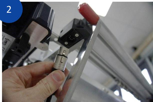
Stecken Sie das Konsolenkabel wie oben gezeigt in den XLR-Anschluss.
