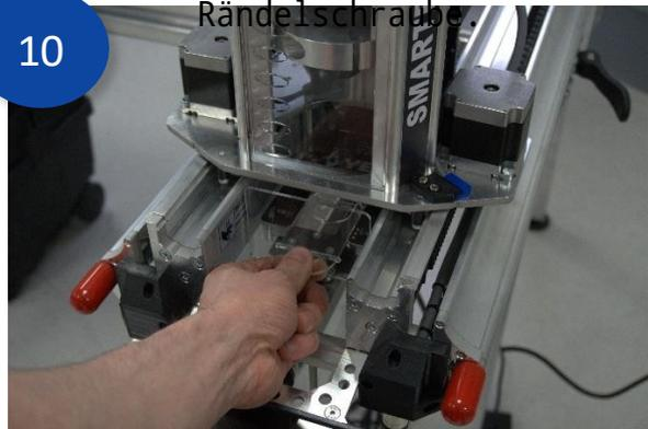
Stecken Sie den Stecker des Staubschuhs in die Vorderseite des Staubschuhs.
