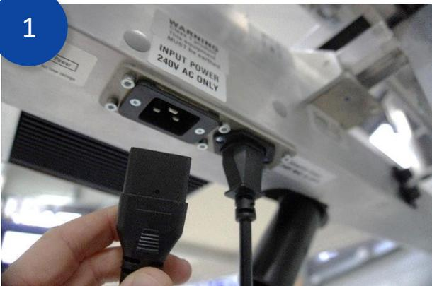
Der Eingang für das Stromkabel befindet sich an der Unterseite des X-Beam Lower.
