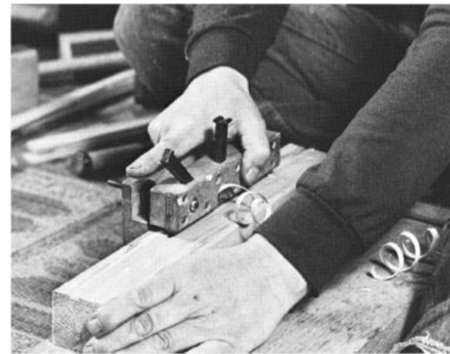
Zum Aushobeln von ganz schmalen Nuten wird der kikai-shakuri-kanna (Maschinen-Nuthobel) benützt.
