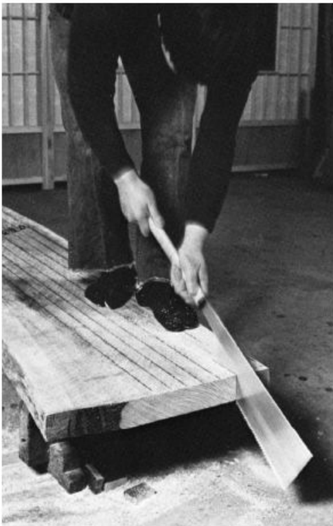
Alle Sägen werden genauso angesetzt wie diese kataba-nokogiri : mit dem Daumnagel der linken Hand als Führung. Zuerst sägen Sie mit kurzen Zügen und nur mit dem ersten Drittel des Blattes und dann verlängern Sie nach und nach die Sägezüge.
