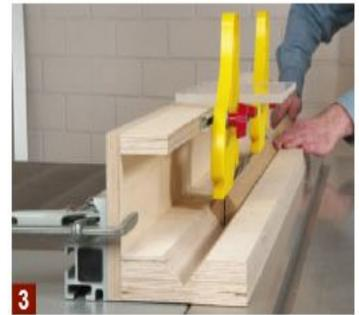
3 ... zur vorderen Andruckfeder von Hand vor-schieben. Ab dort mit einer mindestens 600 mm langen Restholzleiste die Quadratleiste bis hinter das Sägeblatt schieben.
