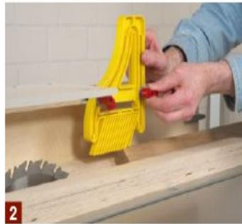
2 Und so benutzen Sie die Schneidlade: Quadratleiste einlegen und vordere Andruckfeder auf die Leistenkante absenken. Aufgrund des Sägeschnitts, verliert die Leistenkante etwas an Höhe, daher die hintere Andruckfeder etwa 2 mm tiefer einstellen. Dann die Quadratleiste auf der V-Nut liegend durch das Sägeblatt schieben. Die Leiste nur bis ...
