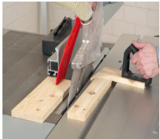
... Druck ausüben dürfen. Üben Sie niemals seitlichen Druck auf das Sägeblatt bzw. die Schnittfuge aus. Mit der keilförmigen Spitze des Seitenstoßholzes können Sie dann auch gleich den Abschnitt links vom Sägeblatt wegziehen. Auf diese Weise kommen beide Hände niemals in den Gefahrenbereich des Sägeblatts. Eine absolut sichere Angelegenheit!
