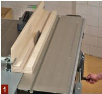
1 So sägen Sie den Sägeblattschlitz in die Schneidlade: Spaltkeil abmontieren und Sägeblatt komplett absenken. Dann Schneidlade am Parallelanschlag befestigen und das laufende Sägeblatt komplett nach oben drehen. Um den Schlitz zu verlängern, Sägeblatt wieder absenken, Schneidlade etwas verschieben und mit Sägeblatt erneut einsägen.
