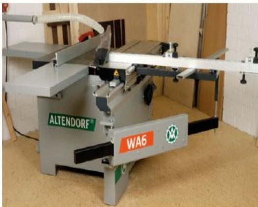
Die Altendorf WA 6 ist eine solide Formatkreissäge, die mit manuellen Handrädern bedient wird. Mit ihren kompakten Maßen, dem 4KW-Motor und Rollwagenlängen bis zu 2,6 Metern wird eine solche Formatsäge aber eher im ambitionierten Hobbybereich oder beim Profi als Zweitmaschine eingesetzt.
