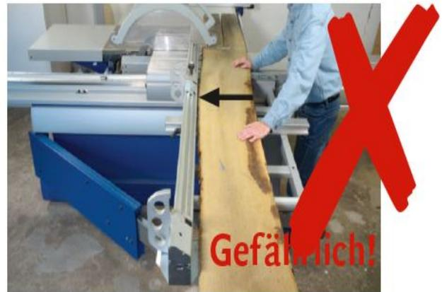
Ist die Waldkante gebogen und liegt nur mit einem Punkt (Pfeil) am Ablänganschlag an, wird die Bohle beim Sägen garantiert verrutschen. Dabei kann es zu gefährlichen Rückschlägen kommen und das Sägeblatt wird im Schnittkanal so stark verbogen, dass es Kerben in den Alu-Schiebetisch schneidet.
