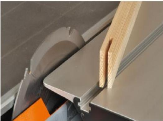
Sollen tiefe Schlitz- und Zapfenverbindungen hergestellt werden, kommt das sogenannte Schlitzsägeblatt mit 5 mm Flachzahnbreite zum Einsatz.
