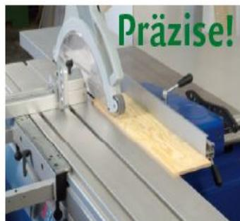
Zwar nicht so gefährlich wie das obige Szenario, aber ein Breitenzuschnitt am Ablänganschlag erfüllt bei einem derart schmalen Werkstück nur selten die geforderte Präzision. Dafür ist die Anlagekante des Werkstücks am Ablänganschlag einfach zu kurz. Deutlich mehr Anlagefläche ergibt sich in diesem Fall am Parallelanschlag, der für den Breitenzuschnitt in aller Regel die bessere Wahl ist.
