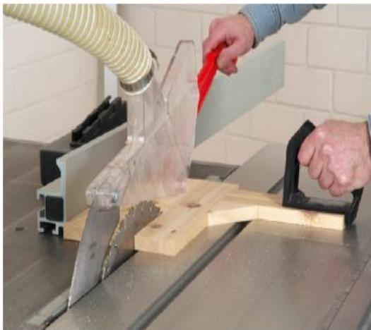
Eine tolle Ergänzung zum Schiebestock ist ein solches Seitenstoßholz. Die in der Schweiz und Österreich sehr populäre Führungshilfe sorgt dafür, dass sich bei schmalen Abschnitten von weniger als 120 mm links vom Sägeblatt auch die linke Hand immer weit genug aus dem Gefahrenbereich befindet. Wichtig ist aber, dass Sie mit dem Seitenstoßholz nur vor dem Sägeblatt seitlichen ...
