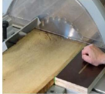
Immer dann, wenn die Schnittqualität keine Rolle spielt, sollten Sie das Sägeblatt in die höchste Position bringen. Weil die Sägezähne dann in einem steilen Winkel auf das Werkstück treffen, wird der Schnittdruck deutlich besser auf den Maschinentisch abgeleitet und die Rückschlaggefahr ist geringer. Auch die Schneiden werden weniger belastet, weil der Schnittweg kürzer ist. Einziger Nachteil: Starke Ausrisse auf der Unterseite!
