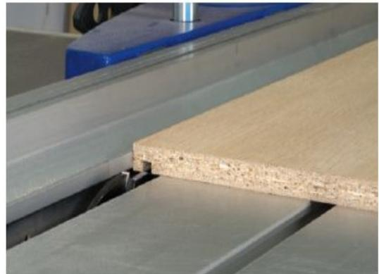
Das Herstellen von breiten Nuten in nur einem Arbeitsgang ist die Domäne eines Verstellnuters. Dieser Fräser eignet sich aber auch sehr gut zum Falzen.
