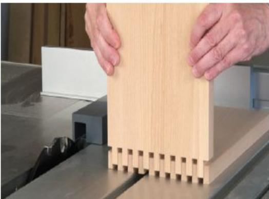
Mit dem Verstellnuter und einer speziellen Vorrichtung gelangen Ihnen auf der Formatsäge auch präzise Fingerzinken in dicke Bretter und Plattenwerkstoffe.
