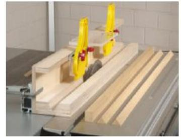
sägt haben, schrauben Sie noch ein Stück Acrylglas als Schutz über den Bereich des Sägeblatts. Direkt vor und hinter dem Acrylglas befestigen Sie zum Schluss noch die beiden T-Nuttschienen für die Andruckfedern.
