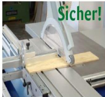
Ein schmales, aber langes Werkstück niemals mit der Schmalseite am Parallelanschlag vorbei führen. Aufgrund der Werkstücklänge und der kurzen Führungskante kommt es hier blitzschnell zu einem Verkanten des Werkstücks. Die Folge: Ein gefährlicher Rückschlag und ein vermurkstes Werkstück. Ablängen schmaler Werkstücke immer am Schiebetisch samt Ablänganschlag durchführen!
