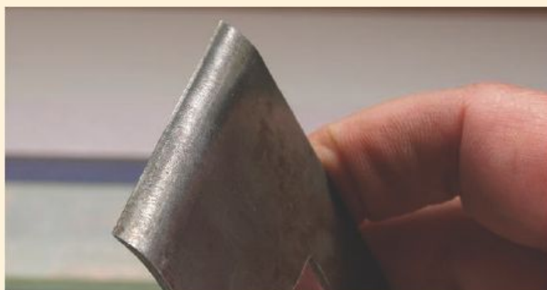
Dieser Spanbrecher ist korrodiert und rau und könnte eine Verjüngungskur gebrauchen.
