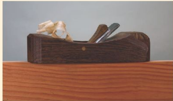
Hobeln in Faserrichtung. Hobel aus Bocote-Holz. Design: James Krenov
