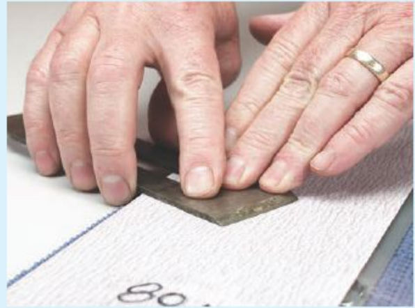
Früher richtete man die Spiegelseite ab, indem man sie flach auf einen Stein oder Schleiffolie legte.
