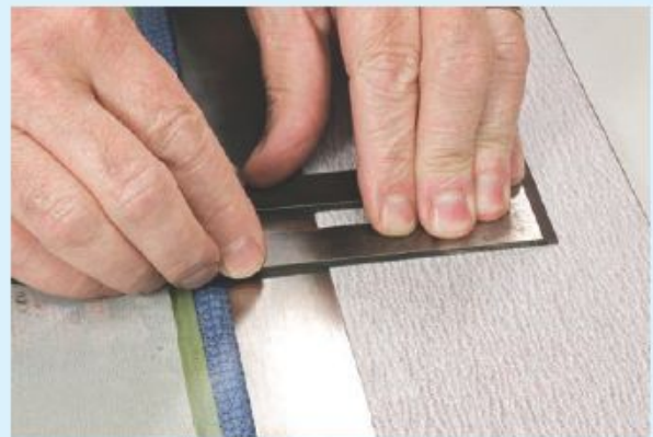
Ein dünnes Metall-Lineal (ein Plastikstreifen oder eine andere Auflage) hebt das Ende des Eisens an und minimiert so den zum Nachschleifen erforderlichen Aufwand.
