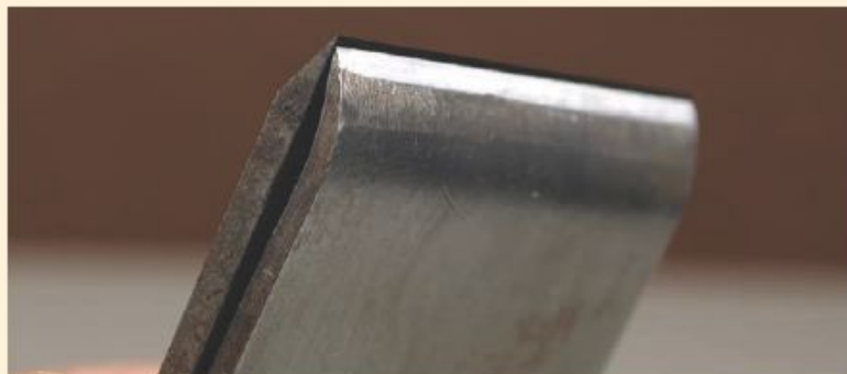
Nahaufnahme eines Spanbrechers mit Hobeisen – in dieser Anordnung sind beide in den Hobelkörper montiert.
