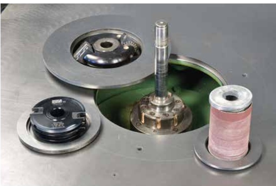
Der Arbeitstisch kann mit den passenden Einlegeringen genau auf den Werkzeughalter abgestimmt werden. Das erhöht nicht nur die Sicherheit beim Fräsen, sondern verbessert auch maßgeblich das Absaugergebnis.
