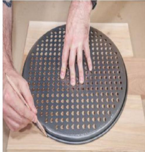
**5 Einen Kreis anreißen.** Sie können zum Anreißen einen großen Zirkel verwenden oder den Umriss anhand einer runden Backform aufzeichnen. Hier wird die Verwendung einer Pizzaform mit 370 mm Durchmesser als Schablone gezeigt.
