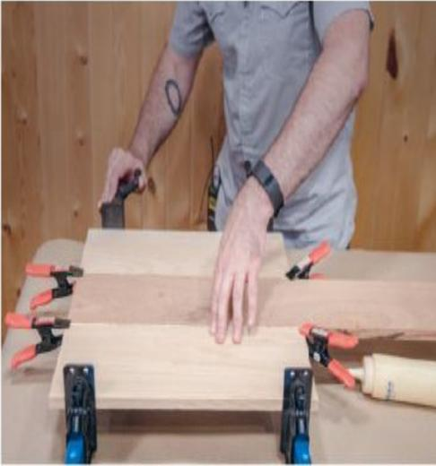
**4 Verleimen.** Geben Sie Leim an die Kanten und spannen Sie die drei Stücke ein. Achten Sie darauf, dass die Kanten bündig sind und die Flächen fluchten. Mit Federklemmen an den Fugen kann man dafür sorgen, dass die Stücke sich nicht verschieben.
