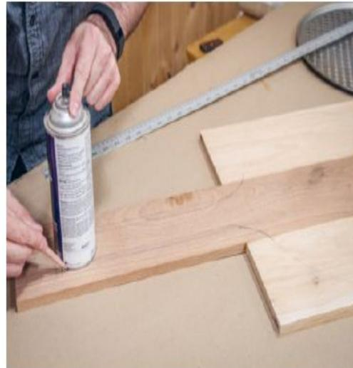
**7 Das Griffende abrunden.** Zeichnen Sie am Ende des Griffs einen weiteren Kreis an, indem Sie den Boden einer Lacksprühdose als Schablone verwenden. Zeichnen Sie auch hier einen allmählichen Übergang von dem Kreis zum geraden Teil des Griffs. Die Gesamtlänge des Pizzaschiebers sollte etwa 710 mm betragen.
