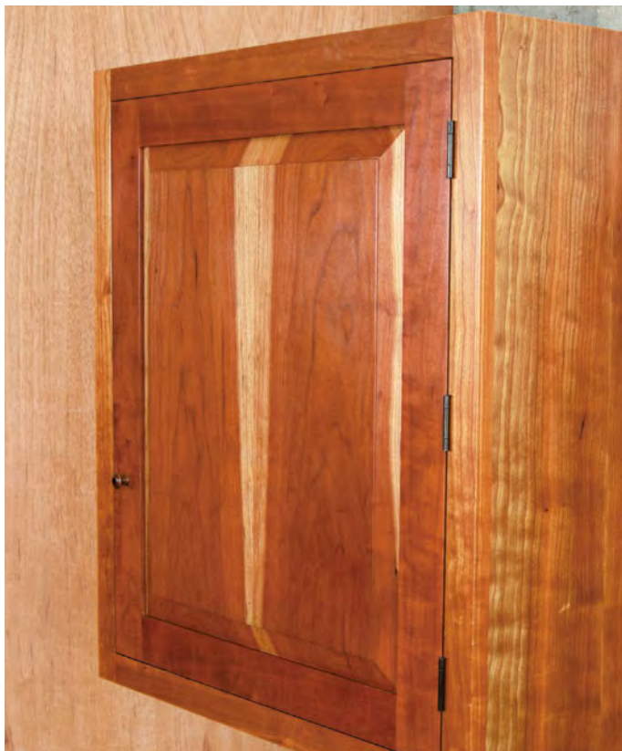
Am Blendrahmen angeschraubt. Diese einschlagende Tür hängt an Möbelscharnieren, die am Blendrahmen eines traditionellen Korpus angeschraubt sind.
