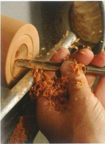
**7** Ziehen Sie die Klinge regelmäßig heraus, um Abfallholz zu entfernen und damit sie sich nicht festfrisst. Um die gewünschte Tiefe zu erreichen, behalten Sie den Schneidwinkel jeweils bei, drücken die Spitze etwa 3 mm ins Holz und ziehen sie in Bogenform von der Mitte bis knapp vor die angerissene Linie nach außen.
