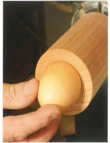
**9** Ist die erforderliche Breite nahezu erreicht, prüfen Sie sie mit dem Ei. Beachten Sie die Lücke zwischen Kante und Ei. Der Eiboden trifft auf den Boden der Aushöhlung, dieser muss daher noch vertieft werden.
