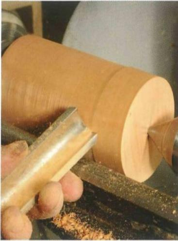
**1** Spannen Sie das Holz zwischen den Spitzen auf und schrumpfen Sie es mit der Schruppröhre zu einer Zylinderform. Belassen Sie dabei den Durchmesser etwas größer als den Fertigdurchmesser.
