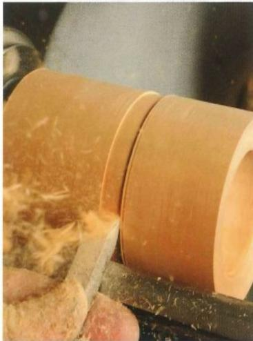
**11** Ist die Innenkontur fertig, messen Sie die Tiefe der Aushöhlung und reißen sie auf dem Außendurchmesser an. Vergessen Sie jedoch nicht: Sie müssen ein wenig hinzufügen, damit Sie beim Formen der Eierbecheraußenkontur nicht in die Aushöhlung hineinschneiden. Mit dem Plattenstahl können Sie nun die für die Becherform erforderliche Tiefe anreißen.
