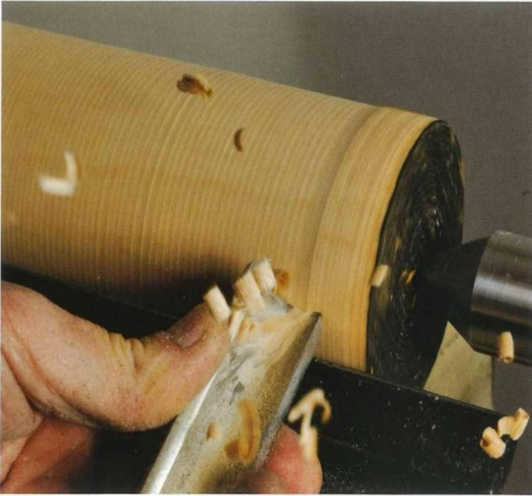
**1** Markieren Sie die Mitten, spannen Sie das Holz zwischen den Spitzen auf und schrappen Sie es mit der Schrappöhre auf eine gleichmäßige Zylinderform. Bei diesem Projekt sind etwa 1200 Umdrehungen/Minute für das Schrappen und 1500–1800 Umdrehungen/Minute für die abschließenden Schnitte eine gute Geschwindigkeit. Wählen Sie aber stets eine Drehzahl, mit der Sie gut zurechtkommen und reduzieren Sie sie im Zweifelsfall.
