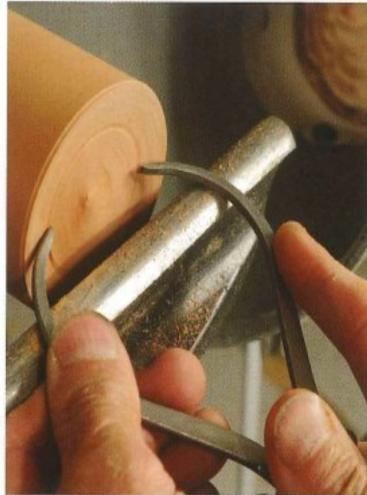
**5** Reißen Sie dieses Maß an der Holzstirnfläche an. Achten Sie darauf, welcher Messtasterchenkel das Holz berührt; läuft Ihre Drehbank gegen den Uhrzeigersinn, darf nur der linke Schenkel das Holz berühren.
