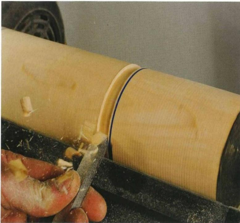
**3** Reißen Sie nun auf dem Werkstück mit Blei- oder Filzstift die Länge der Schlagfläche und die des Stiels an. Machen Sie dort, wo der Stiel auf die Schlagfläche trifft, mit einem Plattenstahl einen Schnitt etwa bis Fertigtiefe.
