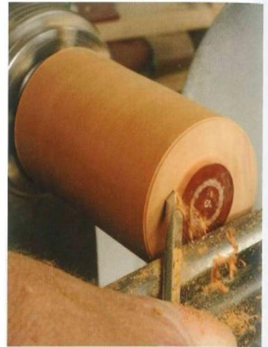
**3** Spannen Sie das Holz in Ihr Spannfutter und drehen Sie das freie Ende mit der Formröhre plan.
