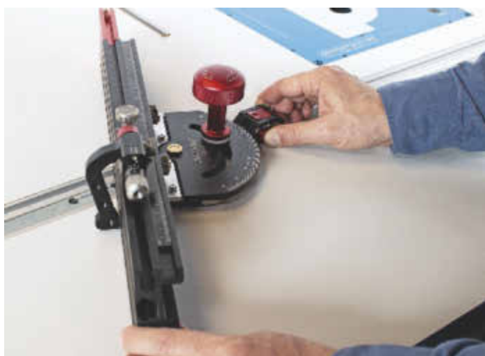
Ein Gehrungs-Winkelanschlag wie der Compass MG-36 von Harvey Industries sorgt für eine stabile Führung des Werkstücks und erlaubt präzise Gehrungsschnitte.
