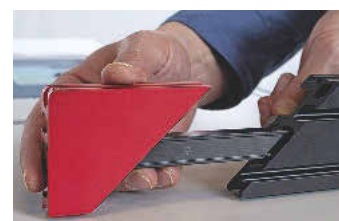
Die Führung des Compass MG-36 lässt sich bis auf 36 Zoll verlängern.
