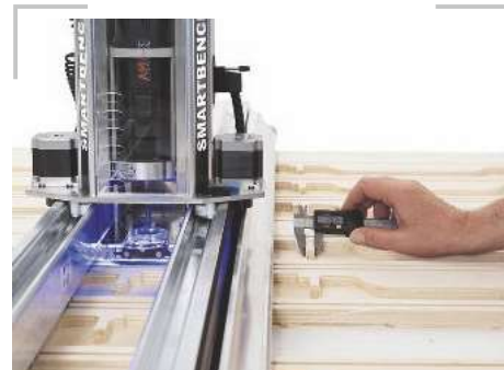
/ Universell einsetzbar: Die Standard-Schaftfräser werden von einem 1000-W-AMB-Aggregat angetrieben.
