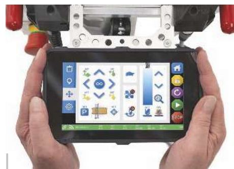
/ Intuitiv bedienbar: Herzstück der Smartbench von Yetitool ist der farbige Touchscreen.
