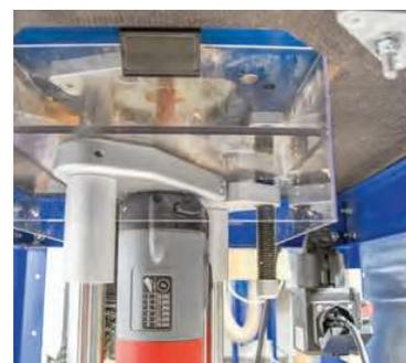
Ein Blick auf die transparente Absaugung zeigt, wie viel zerspanntes Holz beim Fräsen abtransportiert werden muss.
