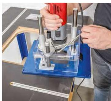
Einfache Montage: Dank des Einsatzes eines schlanken Fräsmotors kann alles zusammengebaut werden, bevor der Lift im Tisch montiert wird.
