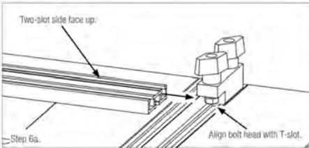
Schieben sie den Bohranschlag mit der hinteren der beiden Profilmuten über die freien Sechskantschraubenköpfe. Achten Sie darauf, dass die Skalierung des Bohranschlags sinnvoll zu lesen ist. Dabei sollten alle Flügelmuttern gelockert sein.
