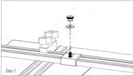
Montieren Sie jetzt den L-Anschlag auf dem Bohranschlag.
