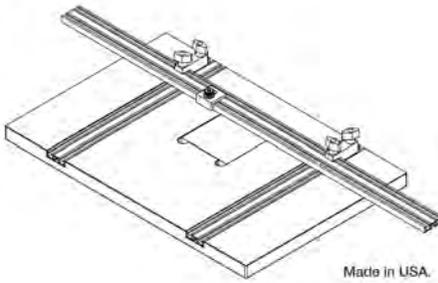
Die Schrauben von unten in den Tisch stecken und die Nutsteine draufschauben. Im Anschluss die vertikalen Profilschienen in die dafür vorgesehene Vertiefungen im Tisch bündig einschieben. Dabei die Nutsteine in die mittige T-Nut der Profilschienen einführen. Danach die Schrauben festziehen.
