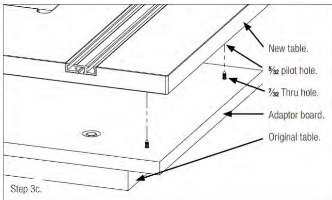
Bohren sie nun vier Löcher in den Überstand der Adapterplatte und schrauben den Woodpeckers Bohrtisch auf die Adapterplatte. Eventuell sollten sie die Platte des Woodpeckers Bohrtisch mit einem dünnen Bohrer vorbohren.
