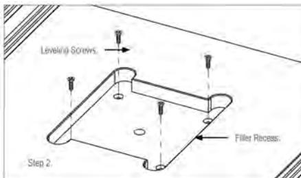
Schrauben sie nun die vier Nivellierschrauben für die Einlegeplatte bündig ein.
