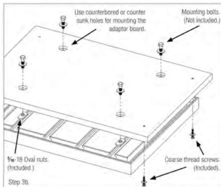
Für einen Bohrtisch mit T-Nuten benötigen Sie eine Adapterplatte, die über Ihren Bohrtisch übersteht, um den Woodpeckers Bohrtisch von unten durch den Überstand anzuschrauben.
