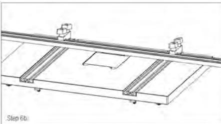
Anhand der vier Flügelmuttern können Sie den Bohranschlag nun vertikal und horizontal einstellen
