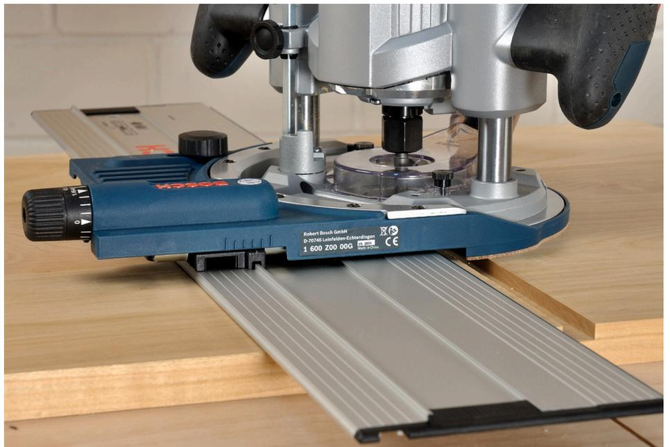
Um den Adapter auf Bosch- und Mafell-Führungsschienen zu benutzen, wird er mit der schmalen Nut auf die Schiene gesetzt. Eine spielfreie Führung ist automatisch gewährleistet und muss nicht nachjustiert werden.
