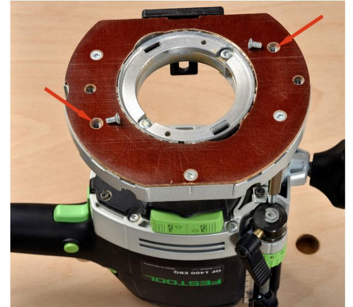
Auch die Festool OF1400 kann mithilfe des Bosch Adapters auf einem Bosch/Mafell-Schienensystem betrieben werden. Dazu werden zuerst die im Bild o. li. mit Pfeilen markierten Schrauben entfernt. Mit zwei längeren M4 x 12 mm Gewindeschrauben mit Senkkopf wird der Adapter anschließend, durch die mit Pfeilen (Bild unten) markierten Löchern, an der Oberfräse befestigt (Lochmarkierungen „C“).
