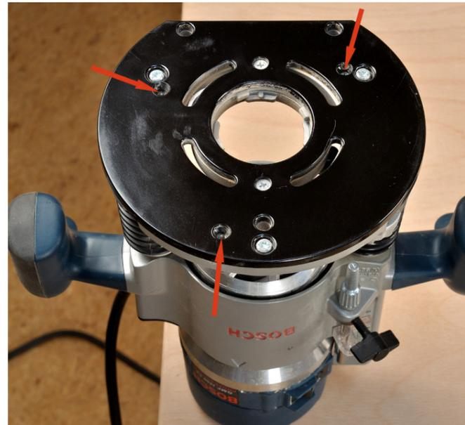
Auch ältere Bosch Oberfräsen wie z. B. die GMF 1400 (Bild) sind mit dem Adapter kompatibel. Weitere Bosch Modelle passen: GOF 900, 1250, 1300, 1400, 1600, 2000 und TE 600 (GKF 600).
