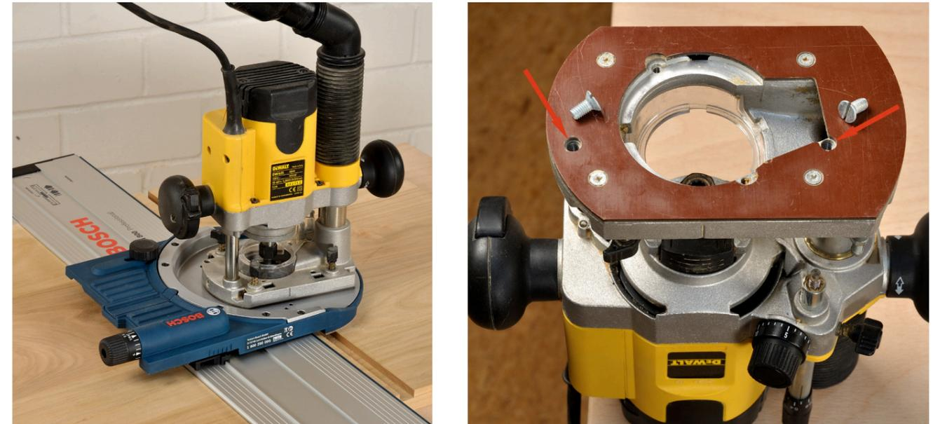
Auch die größere DeWalt Oberfräse DW 621 hat das gleiche Lochbild wie die kleineren Modelle und wird ebenfalls mit zwei M6 x 12mm Gewindeschrauben in den Markierungen „H“ mit dem Adapter befestigt (s. Pfeile Bild unten).
