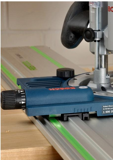
Um den Adapter auf Festool- und baugleichen Führungsschienen zu benutzen wird er mit der breiten Nut auf die Schiene gesetzt.
