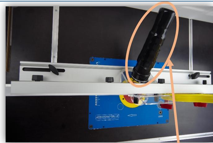
Parallelanschlag mit den langen Schrauben, Distanzhülsen und den großen Flügelmuttern in die vorgesehenen Nuten Ihrer Frätschplatte einschieben.
