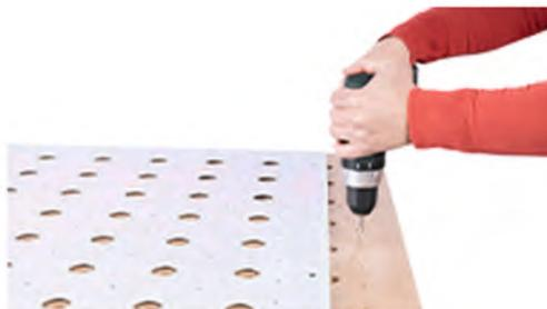
...und danach mit einem  $\varnothing$  8-9 mm Bohrer gebohrt.
