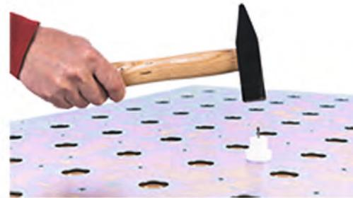
Für das Bohrschema mit 1° Winkelauflösung werden die Bohrlöcher erstmal vormarkiert...
