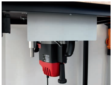
Abb. 14 Schutzschild (stellvertretend abgebildet mit Einbau einer Oberfräse)
