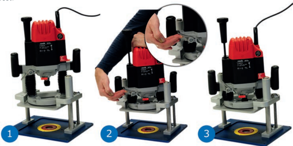
Abb. 10 Fräshöhenverlust minimieren (OFL1.0 stellvertretend)
